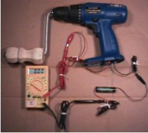
Figure 62: perceuse utilisée comme générateur élec
