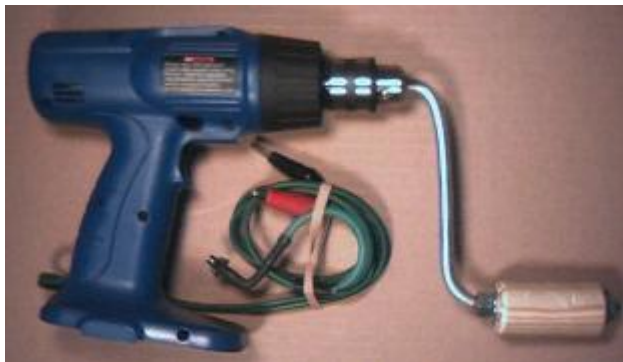
Figure 61: perceuse en générateur
